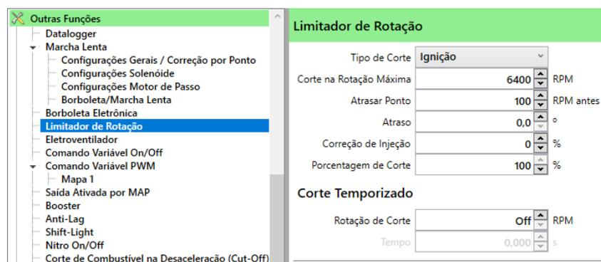
**Tipo de corte:** Determina se o corte está ativado e se cortará injeção ou ignição. Dentre as possibilidades (Desligado, Ignição, Combustível e Ignição e Combustível), o mais utilizado é o de Ignição.
