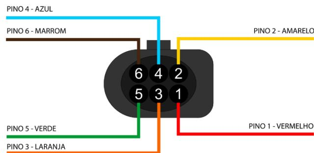
A sonda lambda de banda larga **Bosch LSU 4.9** tem 6 fios no lado do chicote e 5 fios no lado do sensor.
