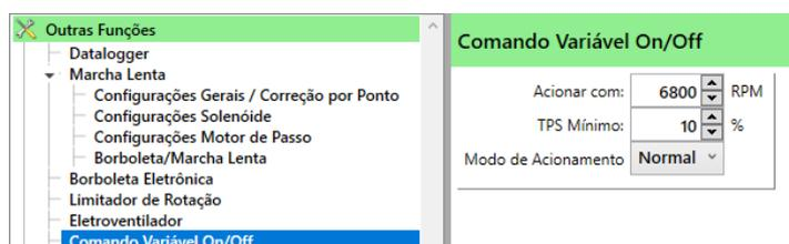
**Acionar com:** O RPM mínimo para acionamento da saída.
