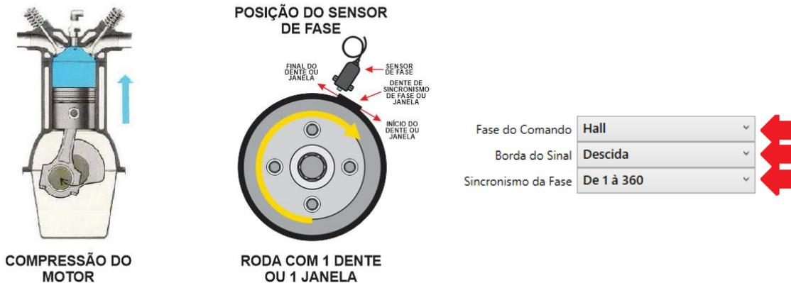
**Atenção:** É importante lembrar que a falha da roda fônica NÃO deve coincidir com a borda do sinal do sensor de fase para essa configuração.
