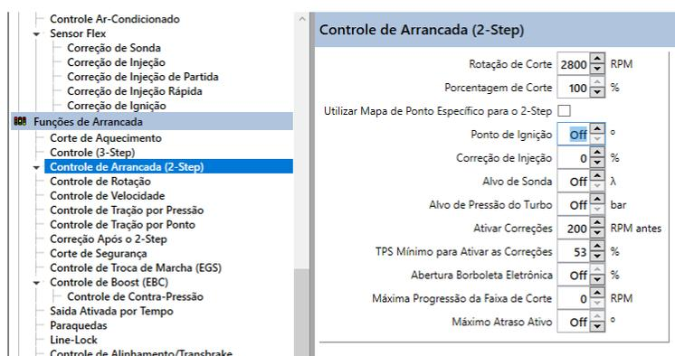
**Rotação de Corte:** RPM limite quando o botão do corte de arrancada estiver pressionado.
