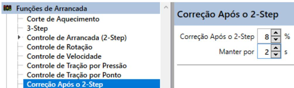
**Correção após o Two-step:** Correção de injeção aplicada após o Two-step.
