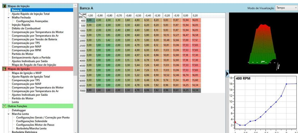
No mapa completo as linhas são controladas por três fatores, a primeira é a própria escala de RPM, a segunda é o parâmetro “Rotação Máxima” e a terceira é o parâmetro “Corte na Rotação Máxima” do “Limitador de Rotação”.
