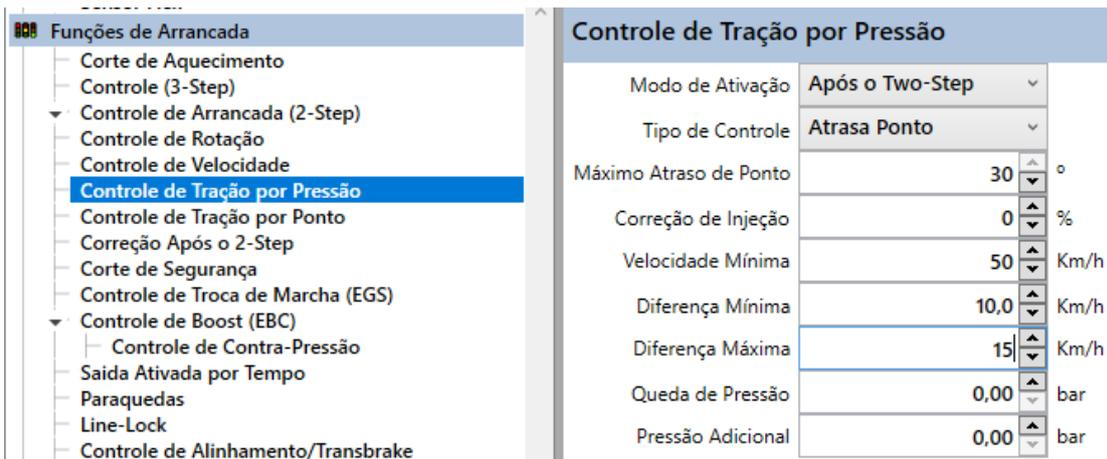
**Modo de Ativação do Controle de Tração por pressão:** Define o modo de ativação do controle de tração, ele pode ser desativado, pode estar ativo o tempo todo, ou ativar apenas após o Two-step.
