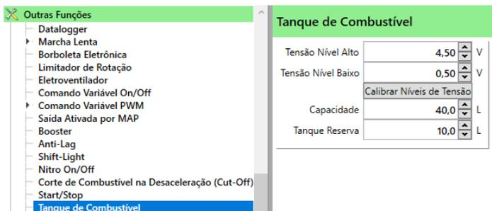
**Tensão Nível Alto:** Configura quanto de tensão o sensor retorna quando o tanque está cheio.
