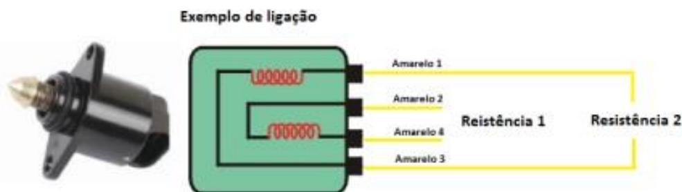
**Lembrando que o motor de passo é calibrado sempre que a ECU é ligada, portanto, antes de dar a partida no motor, é recomendado aguardar 2s após ligar a ignição.**
