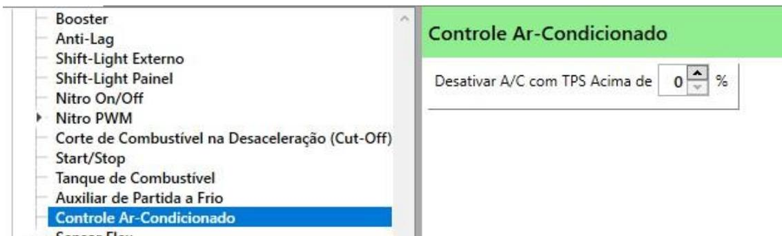
**Define a desativação do Ar-Condicionado:** Seleciona um valor que permite desativar o ar-condicionado quando o TPS ultrapassar o valor informado neste campo.
