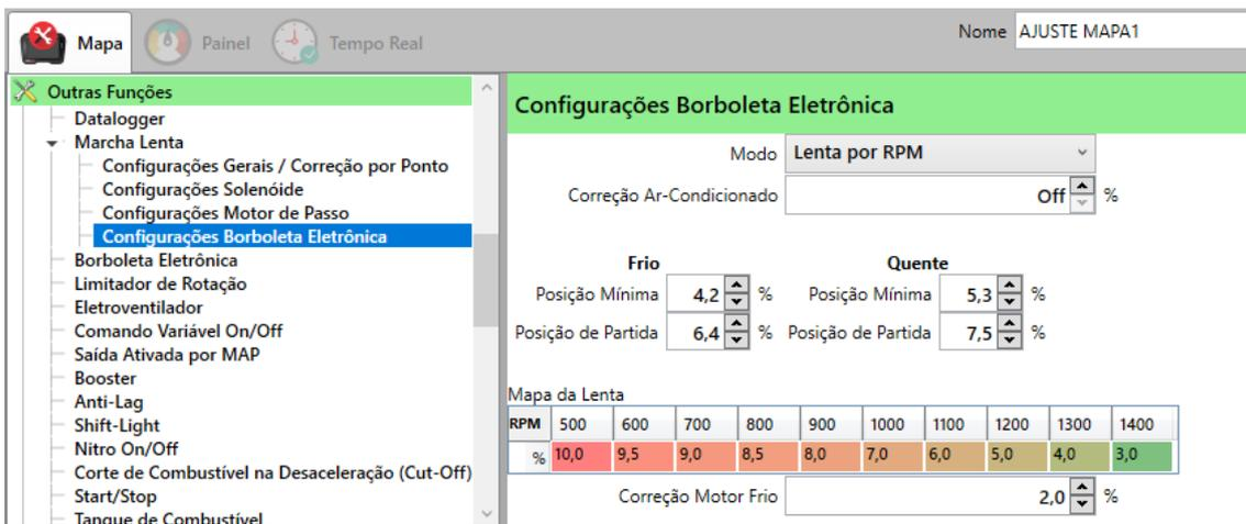
**Modo:** Existem dois modos de funcionamento da borboleta eletrônica na marcha lenta.
