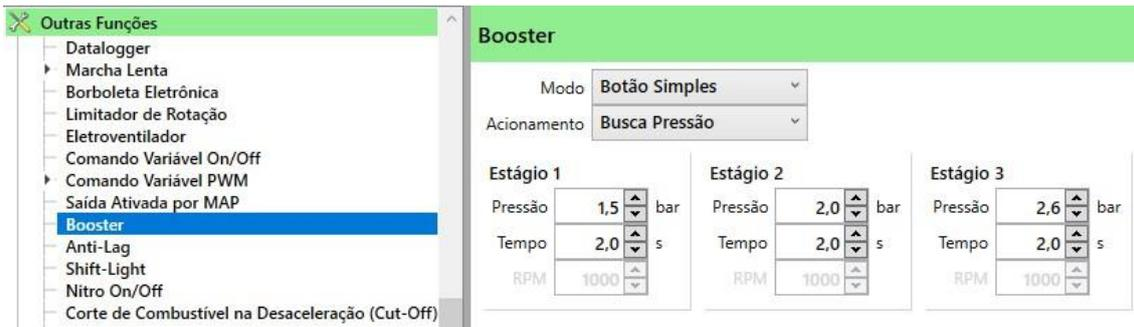
**Modo:** São quatro formas de configuração: Botão Simples, Botão por Tempo, Botão por RPM e Automático por RPM.
