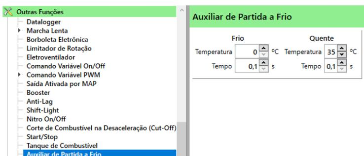
É possível configurar dois tempos e duas temperaturas, permitindo controlar o tempo de acionamento de acordo com a temperatura do motor. O tempo de acionamento é interpolado utilizando esses campos.
