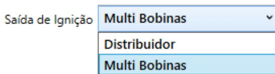
Possui 8 saídas para controle de ignição, elas podem controlar diretamente bobinas com módulo de ignição integrado.
