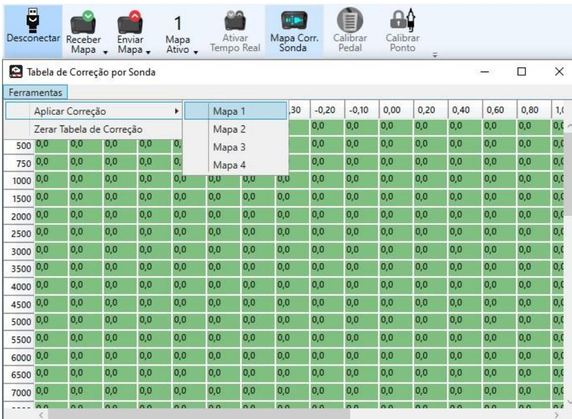
Ao pegar este mapa de dentro do módulo é possível aplicar esta correção em qualquer um dos 4 mapas de injeção, como mostra a figura com o menu na parte superior da janela. Ou então zerar esta tabela para que o módulo inicie uma nova correção por sonda.
