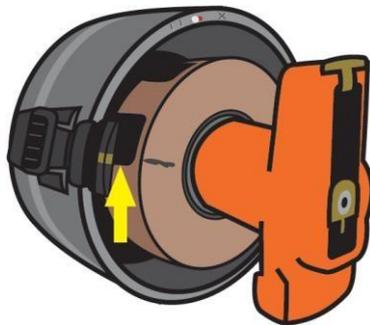
Para deixar maior a janela que está passando pelo sensor, retire material da borda de subida do sensor, nesse caso o distribuidor gira para a direita, então a parte da janela que será maior é a indicada na foto.
