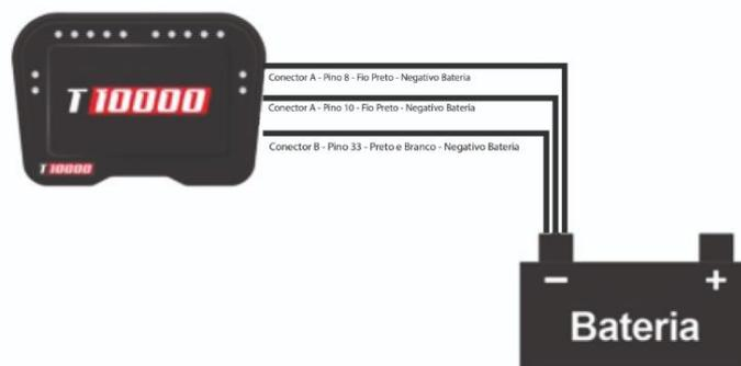
importante que estes terras tenham um bom contato elétrico com a terminal da bateria.
