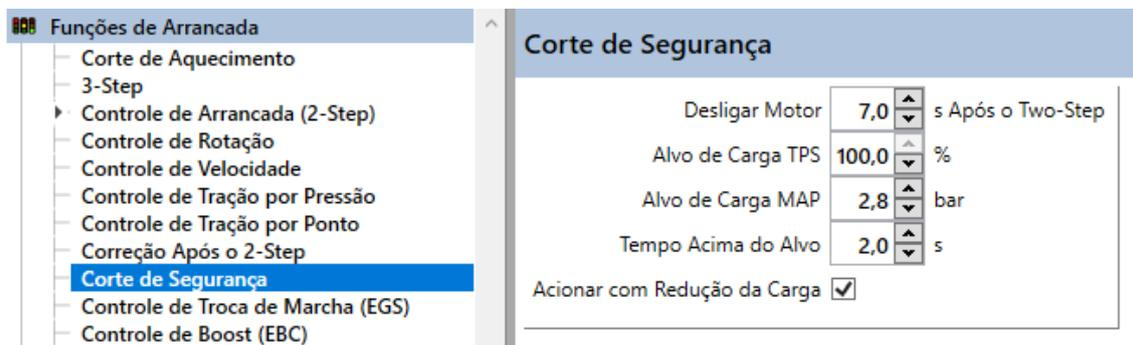
Além do tempo este controle tem uma verificação de carga, podendo ser TPS, ou MAP, ou ambos. Essa verificação de carga serve para validar a puxada. Caso as cargas não fiquem acima dos limites estabelecidos pelo tempo estabelecido, o corte não é ativado, evitando cortes desnecessários.
