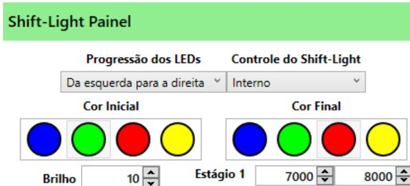
Tem a opção de 3 tipos de progressão de Leds, da esquerda para a direita, de fora para dentro e de dentro para fora,
