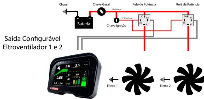
Ainda tem a opção de acionar os 2 Eletro ventiladores via PWM, para esta função e necessário utilizar rele de estado solido.
