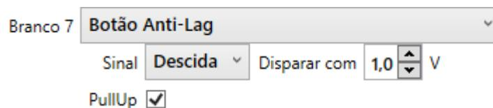
No exemplo acima foi utilizado o Branco 7 como Botão Anti-Lag, sendo o acionamento por negativo por isso da necessidade de marcar o PullUp interno e colocar como Sinal Descida e disparar com abaixo de 1v.
