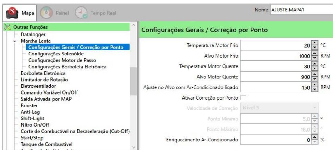
**Temperatura Motor Frio/Quente:** Determina as temperaturas em que o motor é considerado frio e quente durante a marcha lenta. Esses campos influenciam o funcionamento dos atuadores que verificam temperatura.
