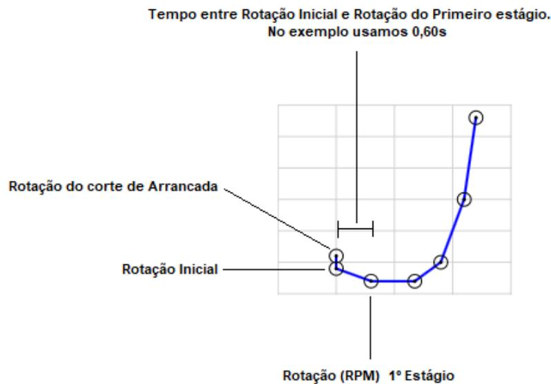
**Referência: Rotação Motor – Rotação Cambio.** Define o RPM de referência para o controle de rotação. Podendo ser pelo motor ou pelo câmbio. Quando estiver a referência definida ele irá fazer os ajustes seguindo conforme configurado no controle passivo.
