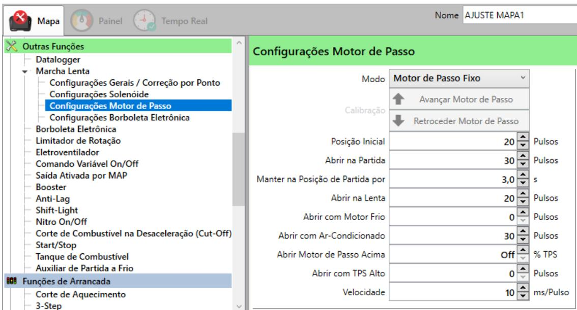
**Modo:** O controle de motor de passo tem dois modos de trabalho: Fixo e Normal. No modo Fixo ao ligar a chave, o motor de passo vai até a posição inicial configurada, e permanece fixo lá. No modo Normal o motor de passo possui bem mais configurações, atuando na partida, no ar-condicionado e na lenta de acordo com a temperatura, sendo assim o modo recomendado para uso.
