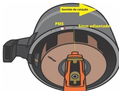
7- Depois de tudo ajustado e fixo, monte o distribuidor no motor.
