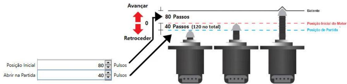
**Manter na Posição de Partida Por:** Tempo em que o motor ficará na posição de partida após o motor pegar. Esta função é semelhante à função “Acionar Solenoide na Partida Por” das “Configurações Solenoide”.
