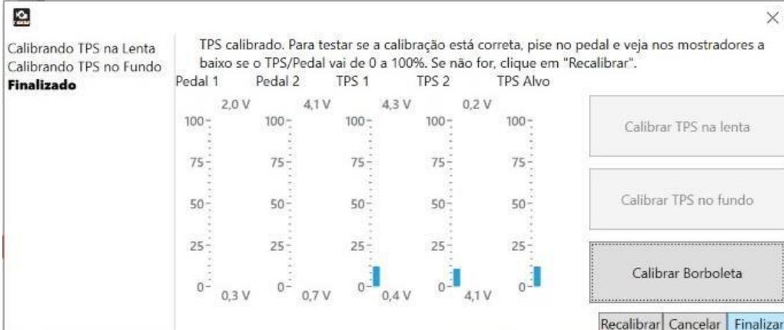
4. Depois de calibrado o Pedal e a Borboleta eletrônica os mostradores Pedal 1, Pedal 2, TPS 1, TPS 2 e TPS Alvo terão que se mover.
