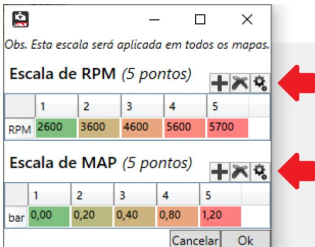
Manualmente é só adicionar os valores desejados e via software clicando na engrenagem de configuração.
