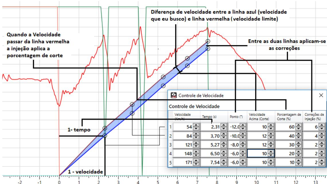
É importante lembrar que o controle de velocidade só libera as correções de ponto e combustível assim como o corte de ignição depois que o Controle de Rotação acaba. O trajeto das linhas começa no ponto 0 mas as correções só serão aplicadas depois do final do tempo do Controle de Rotação.
