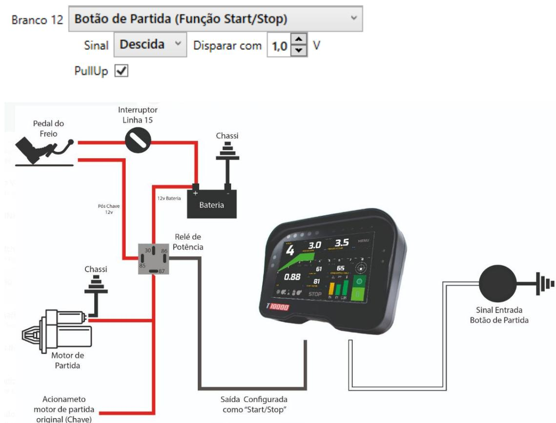
É necessário ativar uma saída como Motor de Partida (função Start Stop) usar um rele para ligar o motor de partida.
