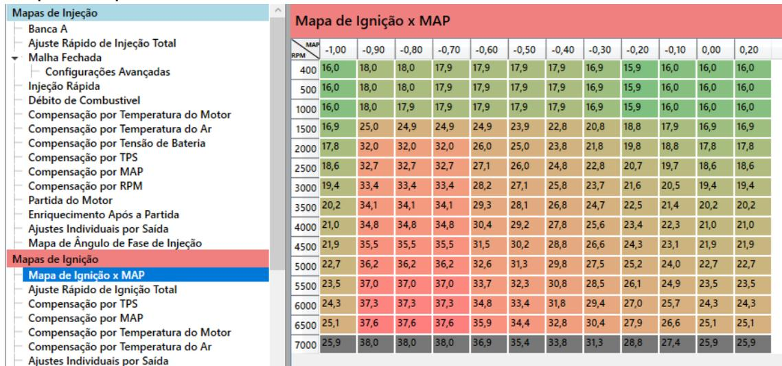
O mapa de ignição x RPM é a base de ponto para seu motor. A T5000 usa esses valores como principais e adiciona ou retira ponto de acordo com a compensação configurada por TPS, MAP, Temperatura do Motor, Temperatura do AR, e Ajuste Individual por Saída.
